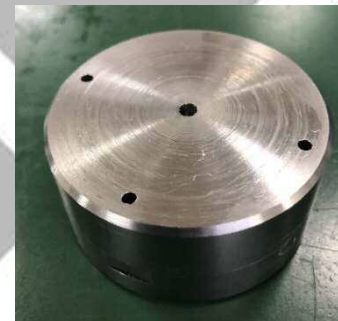
STEP 3 接合でブランク一体化
