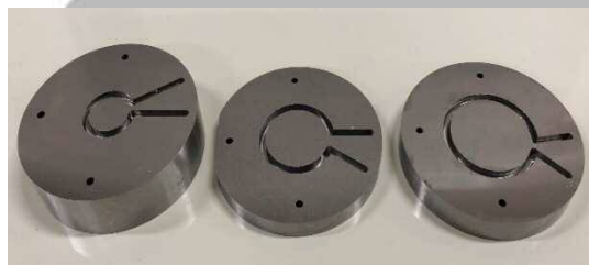
STEP 1 異なる材料を各々切削加工
