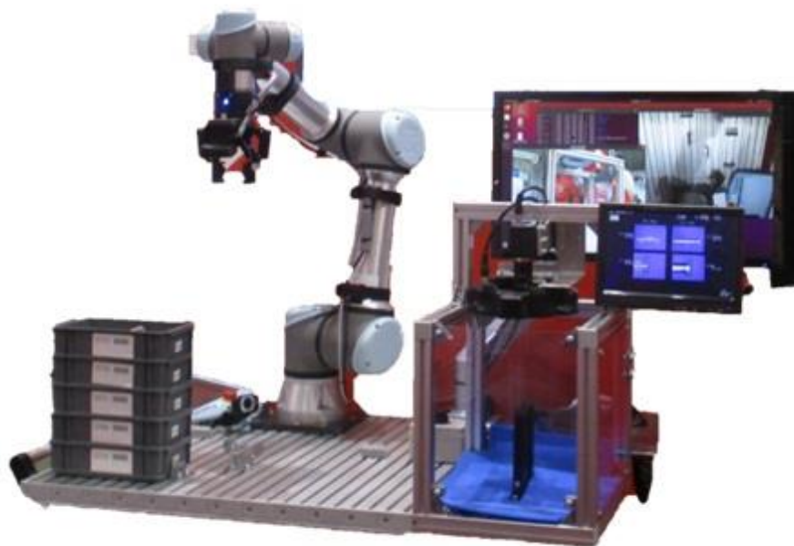
協働ロボット (パンチグループのアスクによる組立)
