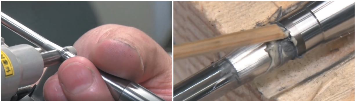
0.001mm単位で寸法を合わせられるのはベテラン職人の技があつてこそだ。一つずつ手作業で金型部品を磨いていく。
