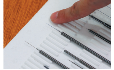
特殊な研削盤でつくった数ミクロンの加工サンプル。髪の毛よりも細かい金型部品が製作できる。
