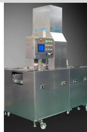
株式会社ASCeのFA機器 製作例 (ニードルレス調味液注入機)
