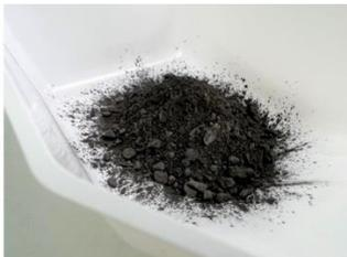
数種類の金属粉末を入れ、細かく粉碎し均一に攪拌。この後特殊な設備で加圧・加熱して焼結。
